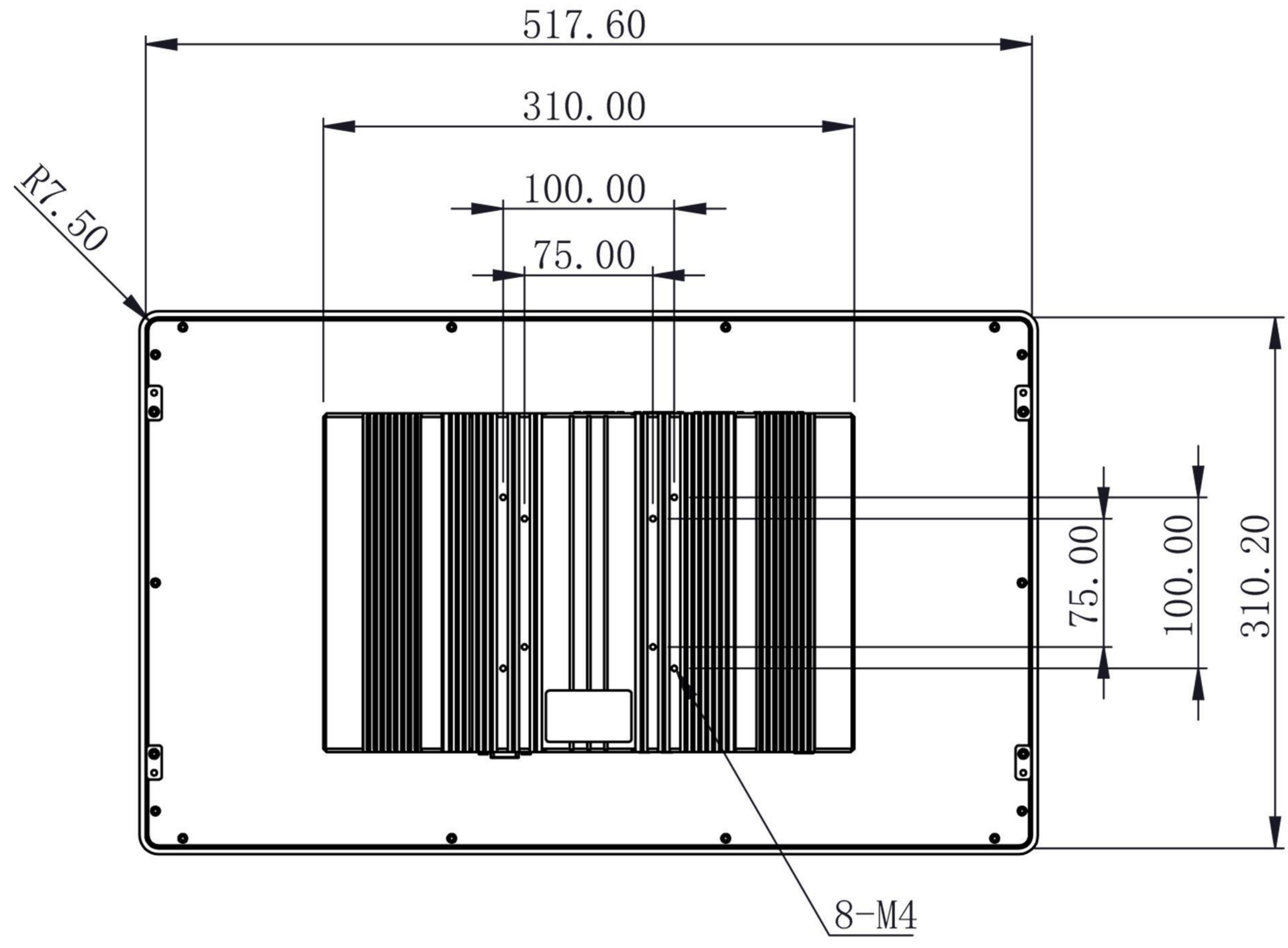
21.5寸EPC-1912工控一体机安装尺寸图
