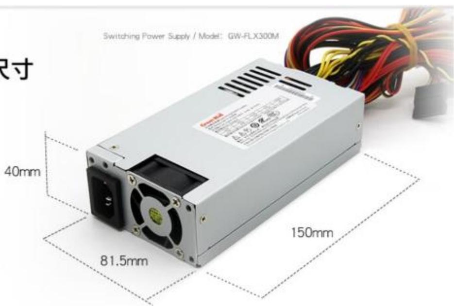
测试方法为：短接电源 24PIN 插头的绿色和黑色线，插上电源，打开电源开关。用万用表测量电压标签上标识的各个颜色电压是否为标准电压，即红色为+5V,黄色+12V, 橙色+3.3V,
